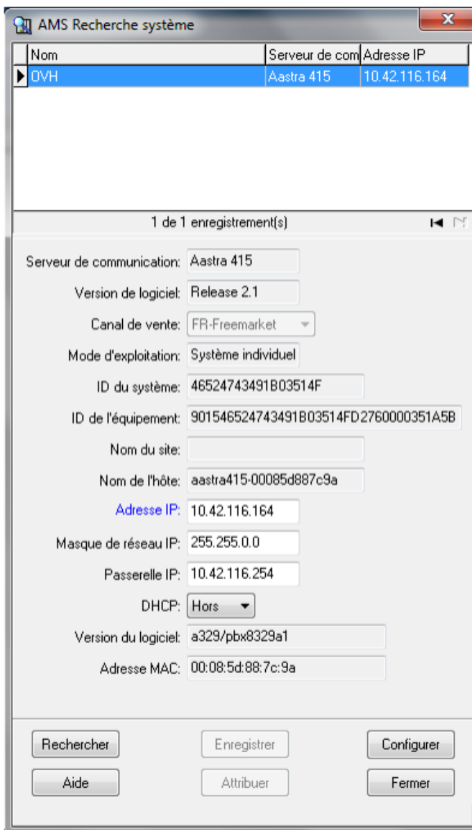
Figure 10 : Fenêtre de recherche de PABX logiciel AMS
