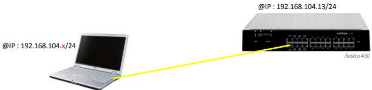
Figure 8 : Schéma connexion entre PC et Autocommutateur
